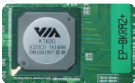
◀ Das 8KRA2+ beruht auf dem VIA-KT600-Chipsatz .
